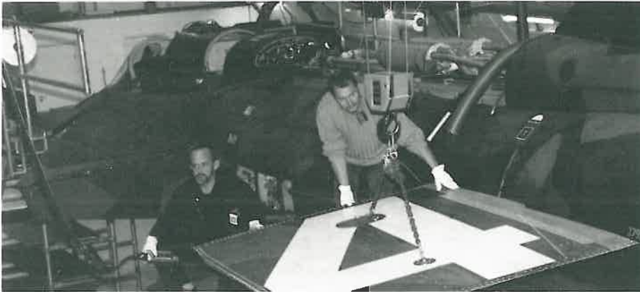
Stig E Jonsson t v och Rune Lehman lyfter inre vingpanel till tank 4
